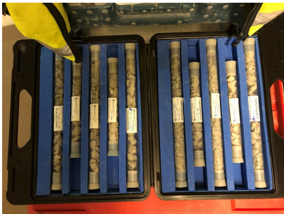
Figur 3 Krossade avjämningsprover i provrör redo för transport
